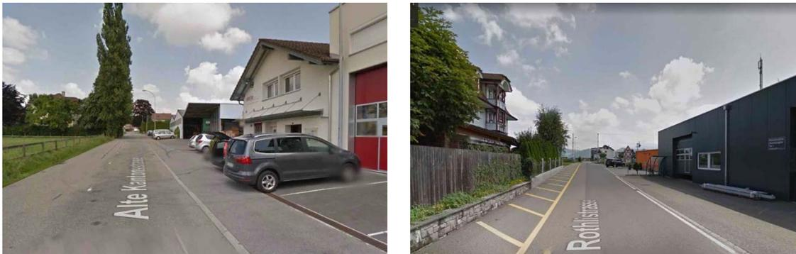
Abbildung 2 und 3: Eingeschränkte Sichtverhältnisse entlang Trottoir aufgrund direkt angrenzender Senkrechtparkplätze und Ein- / Ausfahrten der Gewerbebetriebe (links, Alte Kantonsstrasse) und markierter Fussgängerlängsstreifen (rechts, Rothlistrasse)
